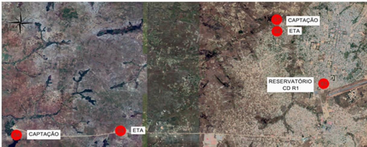
**Figura 2: Localização geral dos sistemas de captação, tratamento e distribuição de água existentes.**
