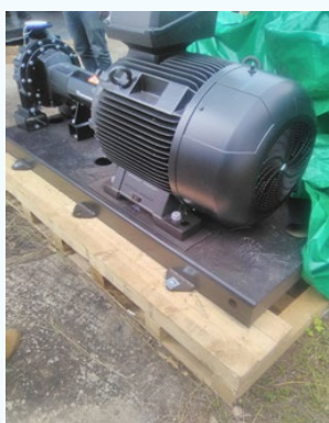
Instalação de 6 novas electrobombas na captação e elevação do SAA de Saurimo
