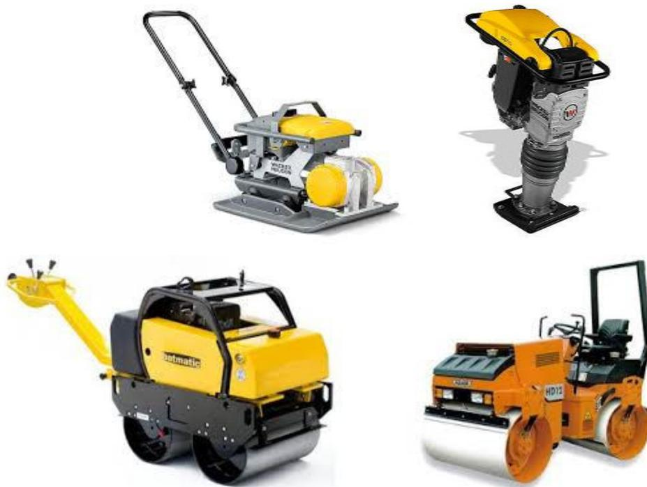
*Figura 22 -- Equipamentos tipo a usar na compactação de aterros em valas*
