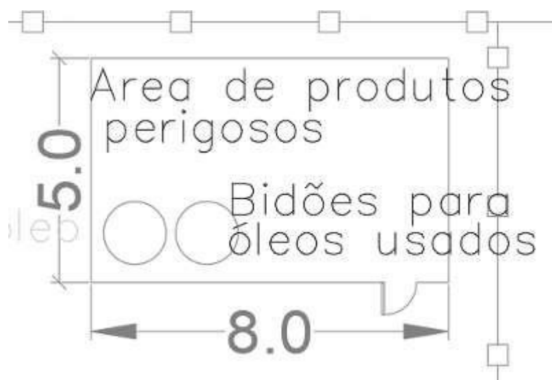
Figura 35 – Área no estaleiro para armazenamento de materiais perigosos líquidos ou aquosos
