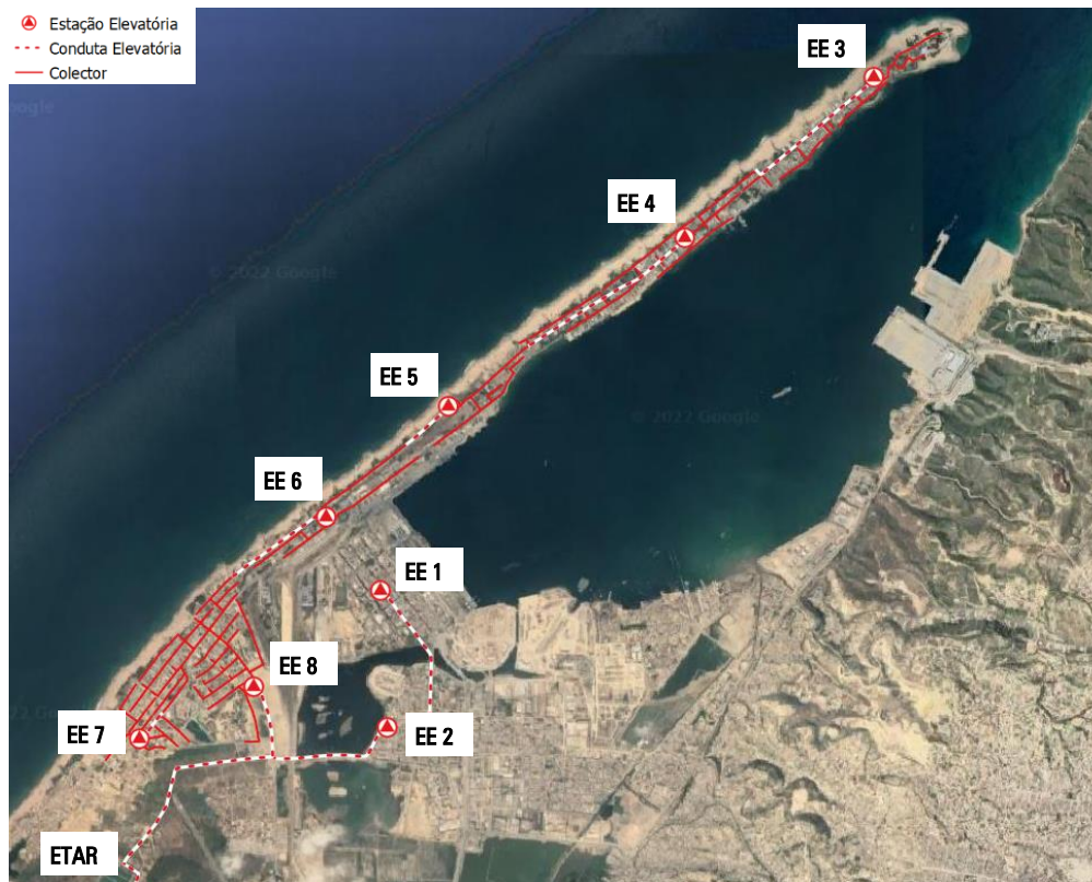
Figura 5.4 – Representação esquemática das infra-estruturas de drenagem previstas: Restinga, Compão, Académico e Comercial (Planta 1/3)
