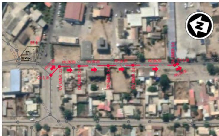
Figura 5.12 – Circuito de by-pass à estação elevatória EE3
