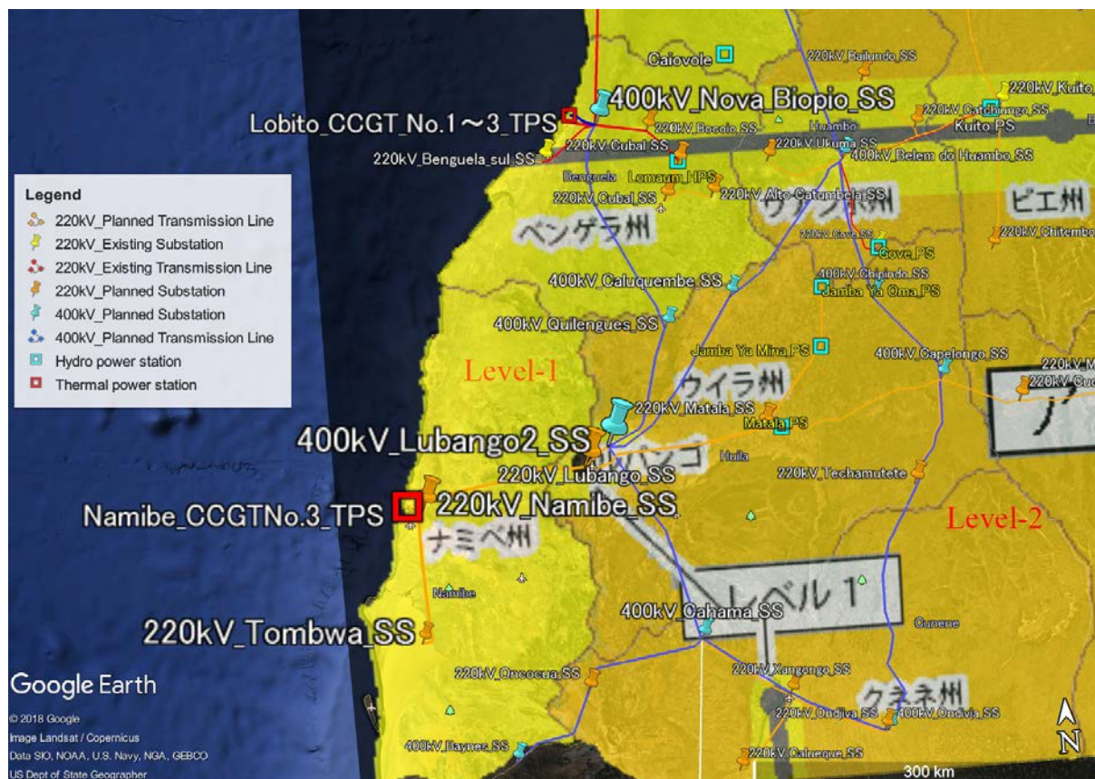
Figura 12-8 O plano de reforço do sistema de transmissão de energia sobreposto ao mapa de riscos
